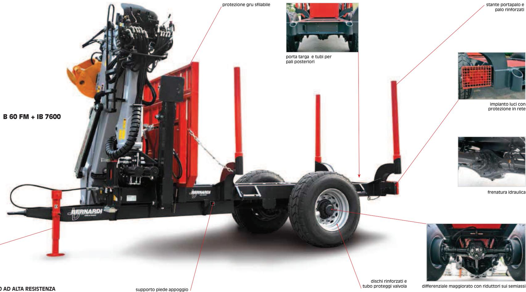
**TELAIO RINFORZATO CON TUBOLARI IN ACCIAIO AD ALTA RESISTENZA**
